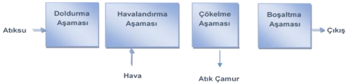
Şekil 4. Ardışık Kesikli Reaktör (AKR) Sistemi Akış Diyagramı
