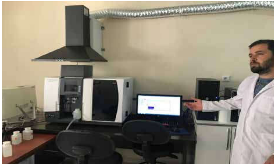
Şekil 38. Meskan Ölmez Madencilik firmasının bünyesindeki laboratuvarda kimyasal analizlerin yapıldığı Atomik Absorpsiyon cihazının görünümü.
