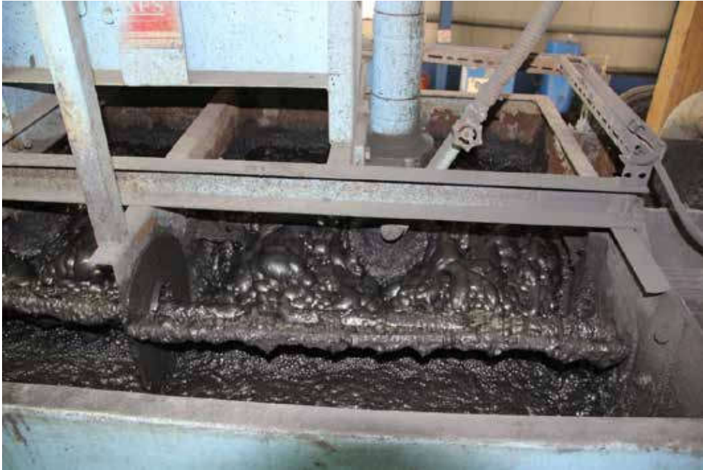
Şekil 28. Köpüklerin etrafına absorblanarak yüzüdürlmüş çinko sülfür.
