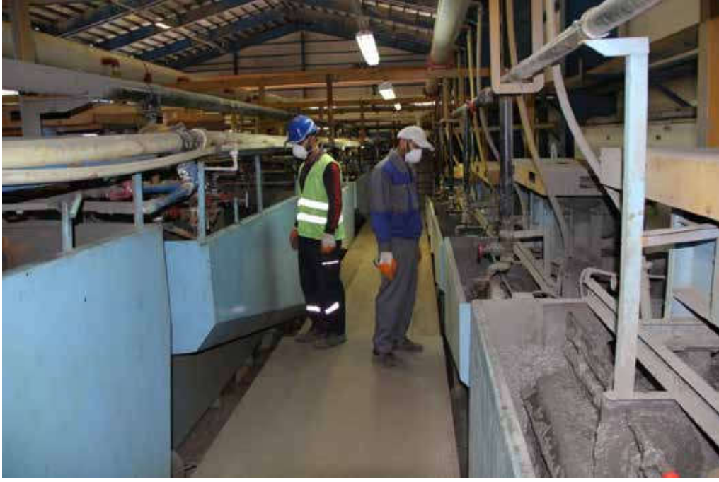
Şekil 27. Sellürlerde çinko sülfürün yüzüdürlme yoluyla zenginleştirilmesi.
