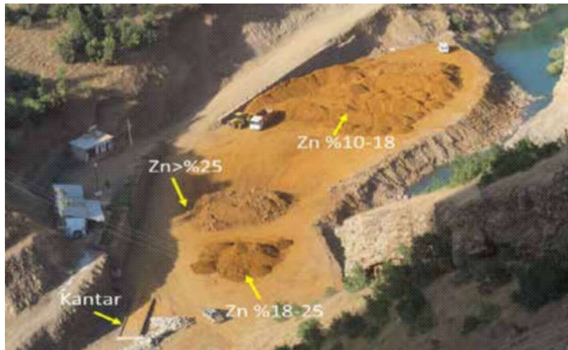
Şekil 24. Karakaya yatağında üretilen farklı tenördeki cevherlerin stoklandığı ana stok sahasının görünümü.
