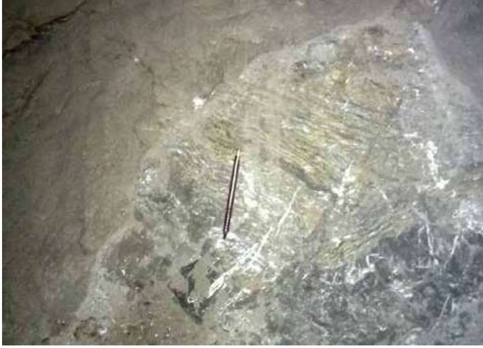
Şekil 15. Pirit ve markazitçe zengin, sfalerit ve galen içeren bantlı sülfürlü cevher tipinin görünümü.
